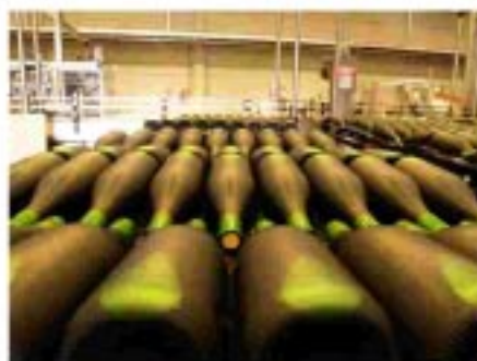
El envase encaja a la perfección evitando vibraciones y desplazamientos y por tanto roturas.
